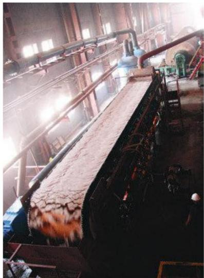
Поверхность фильтрования для ленточных вакуум-фильтров определяется в зависимости от заданной производительности, которая в свою очередь зависит от грансостава, плотности питания и вязкости жидкой фазы и характеристики конечного продукта. Ленточные вакуум-фильтры работают на фильтрации хвостов и флотоконцентратов в калийной промышленности. Возможна пропарка и промывка осадка.
